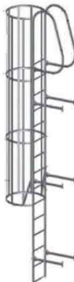
4.2 pav. Principinė priešgaisrinių kopėčių schema.
